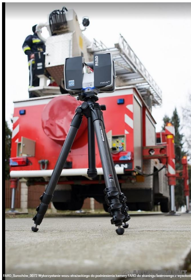
FARO_Surochów_0072 Wykorzystanie wozu strażackiego do podniesienia kamery FARO do skaningu laserowego z wysokości
